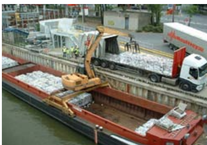
Péniche équipée d'une pince à balles
